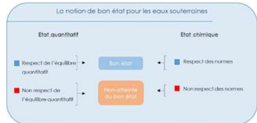
Figure 2 : Notion de bon état pour les eaux souterraines
